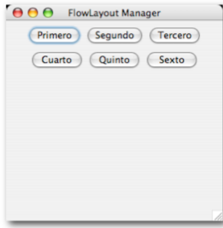
Figura 11.1: Colocación de Componentes con FlowLayout .
